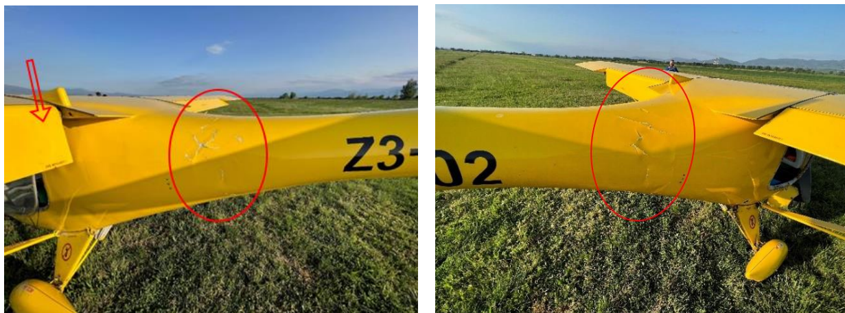
Слика бр.9 и 10: Оштетувања на трупот на Z3-UA-002
