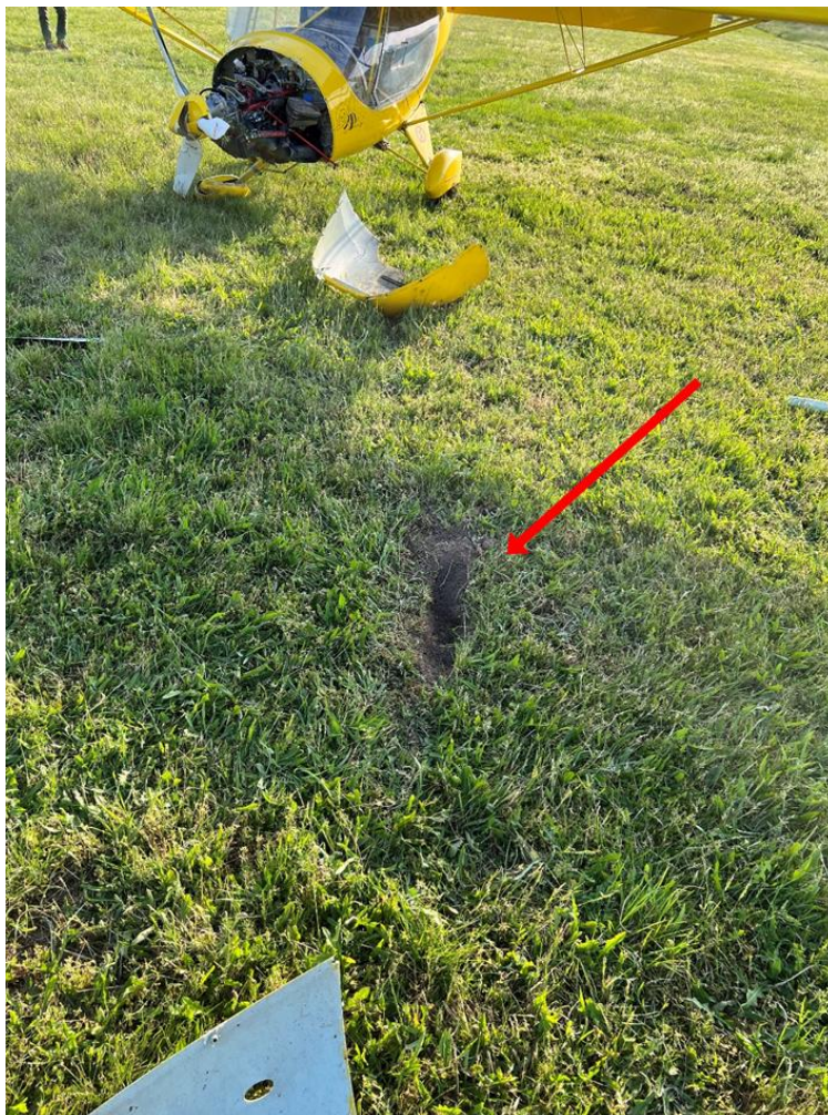
Слика бр.4: Оштетување на ПСП од елисата на воздухопловот
